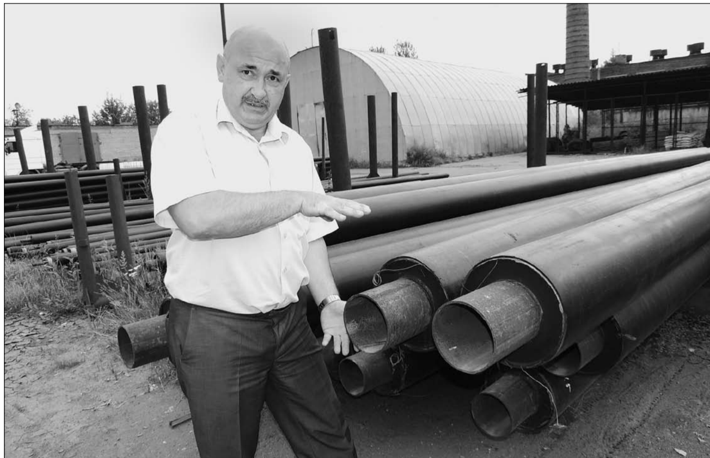
Новые трубы в ППУ изоляции прослужат 25 лет
